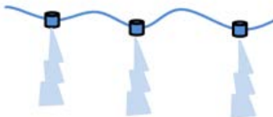
Un asperseur fixé à proximité du matériau à traiter
