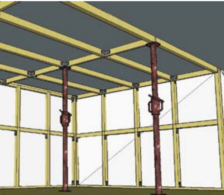
Vue d'une ossature de support de film de propreté en plafond.
